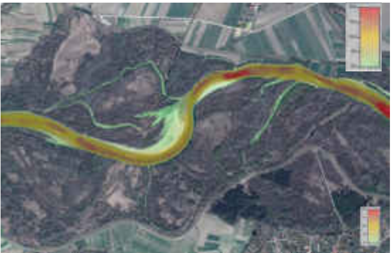
Slika 2.1.2.1.11. Usporedba raspodjele posmičnog napreznaja vode 50%-tnog trajanja na promatranom području za postojeće i projektirano stanje
