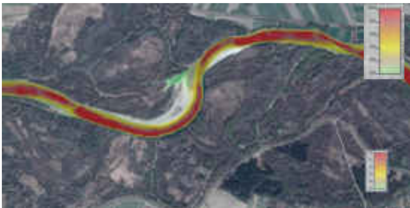
Slika 2.1.2.1.10. Usporedba raspodjele posmičnog napreznaja vode 80%-tnog trajanja na promatranom području za postojeće i projektirano stanje
