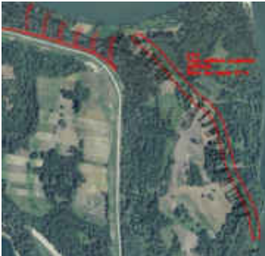
Slika 2.3.1.1. Varijanta 2 - Prokop inicijalnog kanala širine dna korita 27 m (prema projektnom zadatku)
