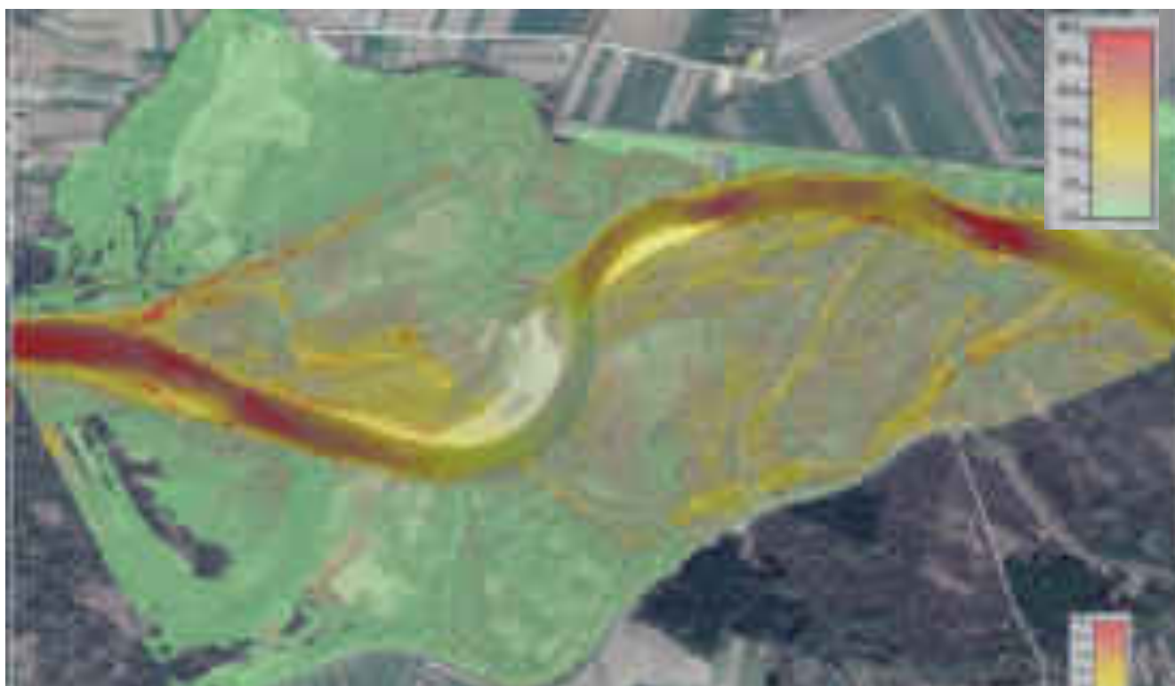
Slika 2.1.2.1.12. Usporedba raspodjele posmičnog napreznja velikog vodnog vala na promatranom području za postojeće i projektirano stanje
