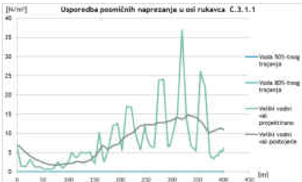
Slika 2.1.2.1.16. Grafički prikaz rezultata posmičnih naprezanja numeričkog modela rukavca C.3.1.1.
