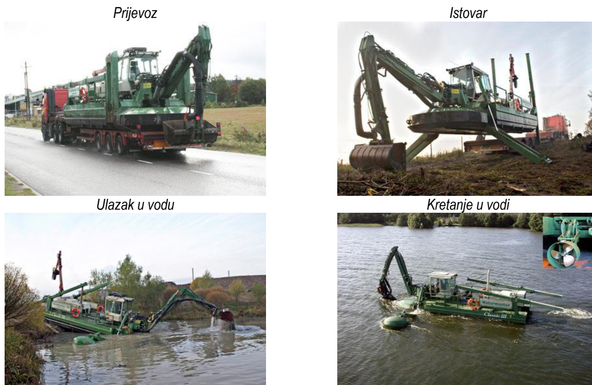
Slika 2.7 Primjer bagera-refulera (Izvor: Idejno rješenje)
