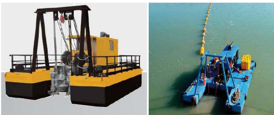
Slika 2.6 Hidraulički bager sa zaštitnim zvonom (lijevo) i u radu s transportnim cjevovodom (Izvor: Idejno rješenje)
